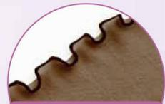
**3 fils roulotté avec ajustement différentiel**
