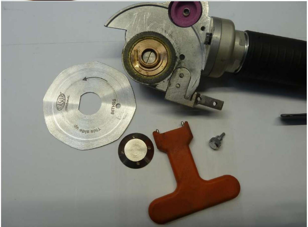
Une fois la lame neuve mise en place il suffit de reprendre les différentes opérations dans le sens inverse
